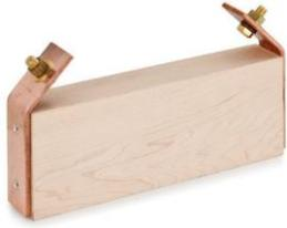
L'adaptateur serré entre la tête et la contre-poupée fournit des bornes pour connecter des câbles 4/0 pour une aimantation à distance.
