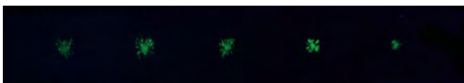
Bloc de test de référence ISO 3452-3 avec pénétrant de la série ZL-400 uniquement.
