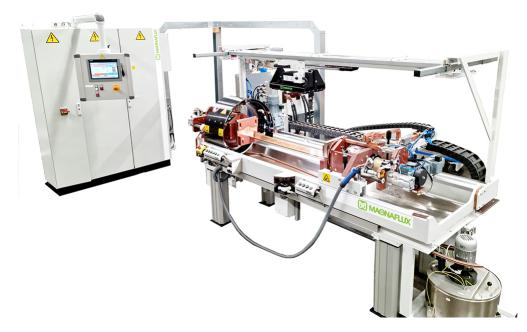
Die stationäre Rissprüfbank Universal SW in der Standardausführung eignet sich zur Prüfung von Werkstücken mit Einspannlängen von 1200 mm (Universal 120 SW) bis 3200 mm (Universal 320 SW). Der lichte Spulendurchmesser beträgt im Basisgerät 400 oder 500 mm. Es können Werk- stücke mit einem Gewicht von bis zu 300 kg (Standard) oder optional 1000 kg geprüft werden.
